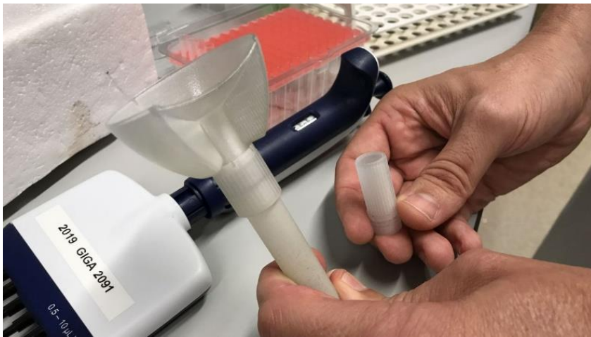
Illustration 1 : récipient à salive libérant automatiquement un liquide d'inactivation lorsque le bouchon est vissé sur le récipient (principe appliqué à l'université de Liège)
