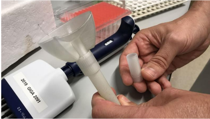
Figuur 1: speekselcontainer met automatische vrijstelling inactivatievloeistof wanneer het dopje op de container wordt geschroefd (principe toegepast in universiteit Luik)
